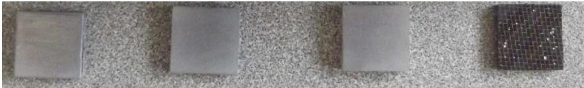
Figure 3.52 Eprouvettes de mesures de conductivité thermique plaque chaude gardée (de gauche à droite : Carall 5-2 tissé, Carall 5-2 UD, Glare et Carbone + BM)
