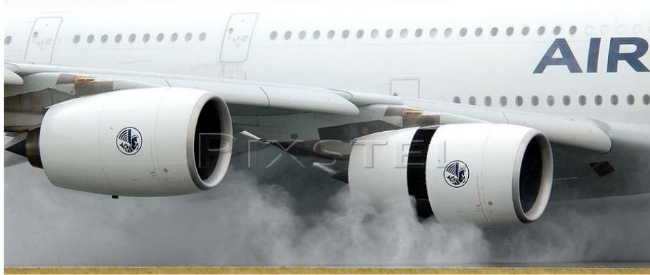
Figure 1.6 Photo d'un inverseur de poussée d'A380 lors d'un atterrissage
