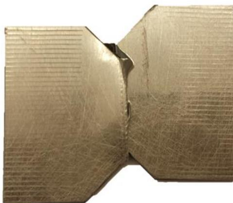
Figure 4.13 Epreuve de cisaillement post-mortem en Carall 5-2 UD
