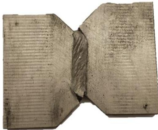
Figure 4.4 Éprouvette de cisaillement post-mortem en Carall 5-2 tissé
