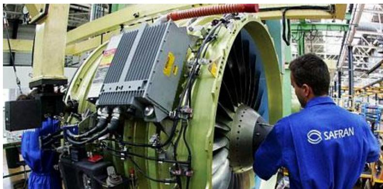
Figure 1.10 Installation d'un FADEC sur un réacteur
