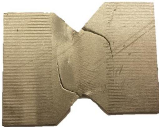
Figure 4.22 Éprouvette de cisaillement post-mortem en Glare 5-2
