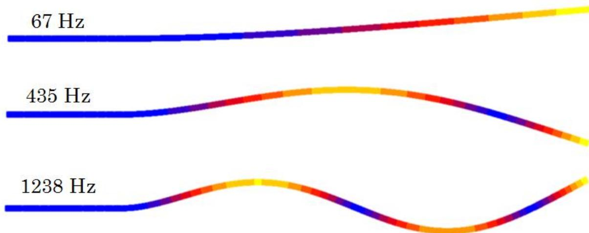
Figure 3.25 Résultats de l'analyse modale avec les trois premières formes propres en flexion
