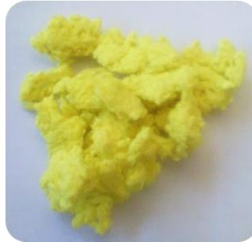
Figure IV:6 Fibres de pâte Kraft-triclosan
