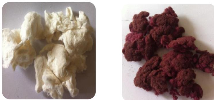
Figure V:22 (a)-P\u00e2te propargyl\u00e9e et (b)- P\u00e2te apr\u00e8s greffage de la Porphyrine neutre
