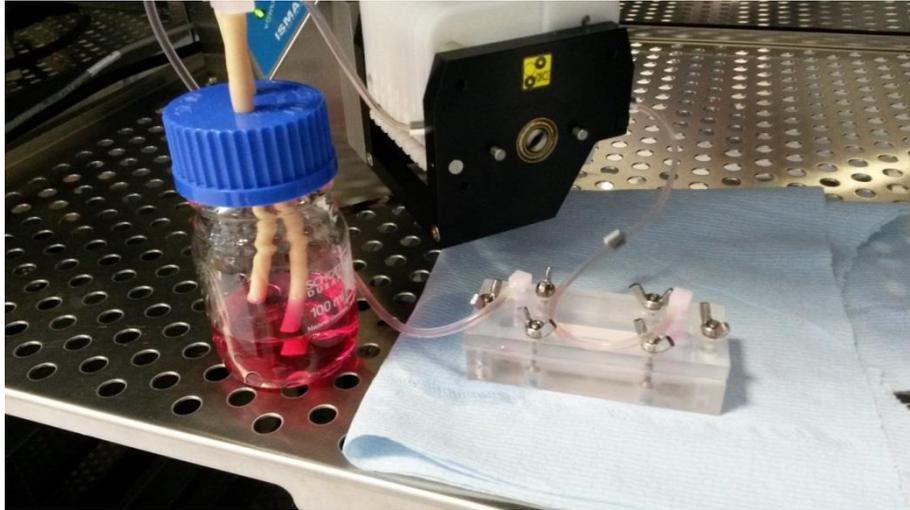
Figure V-3 : Dispositif pendant une expérience de cisaillement sur une lame de corail de bécitier.
