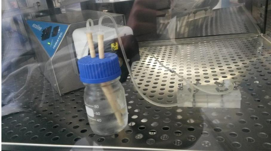
Figure V-1 : Dispositif de cisaillement développé. Sur la photo sont visibles la pompe, le circuit de tubulures, le flacon réservoir et le dispositif en lui-même, fermé hermétiquement grâce à un système de vis-écrous.
