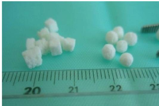
Figure IV-1 : Particules cubiques et sphériques de corail Porites
