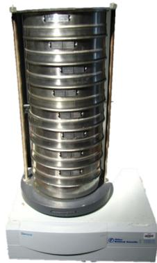
FIGURE 2.3. – Tamiseur RETSCH AS 200 utilisé pour la séparation des grains de préforme.
