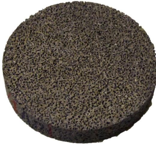
FIGURE 2.1. – Échantillon de mousse métallique.
