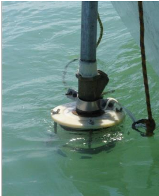
Figure III.4 Echantillonnage de sédiment avec le carottier monotube
