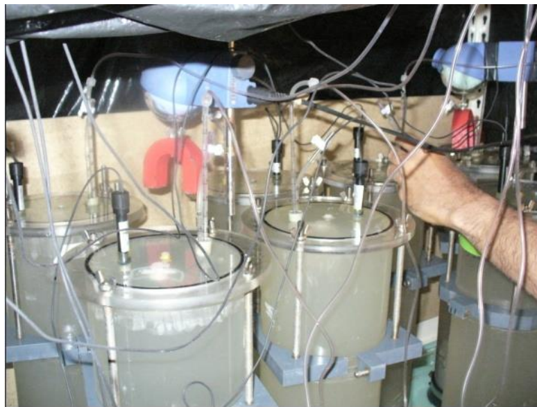
Figure III. 7 Dispositif d'incubation comprenant un moteur Lab-Egg 8W (0-2000 tour/min, en bleu), un aimant U (en rouge), les mini-sondes UNISENSE et un système de prélèvement (entrée – sortie) connecté à la nourrice). On distingue le barreau aimanté blanc sous le chapeau du haut.
