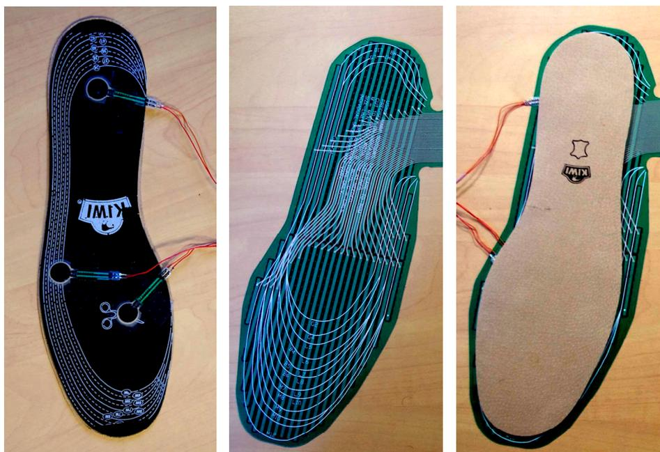
Figure 30 : La semelle instrumentée. Semelle F-Scan. Semelles superposées.
