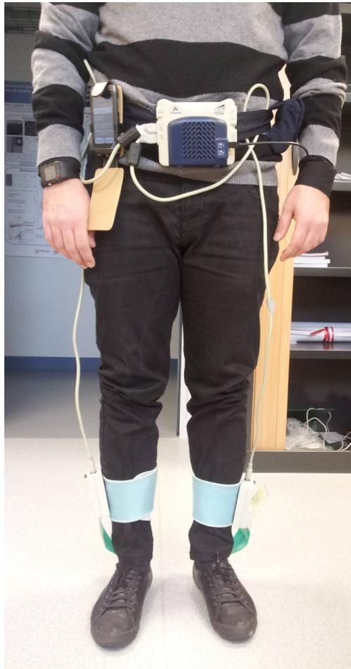
Figure 20 : Semelle F-Scan et centrale d'acquisition de données.
