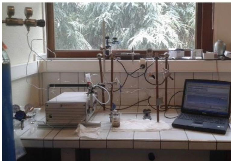
**Figure II.15 : chromatographie en phase gazeuse (Micro GC).**
