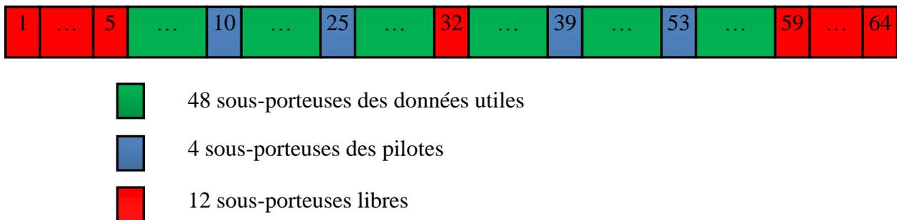
**Figure 2.9.** Répartition de l'ensemble des sous-porteuses d'un symbole OFDM dans le standard IEEE 802.11a
