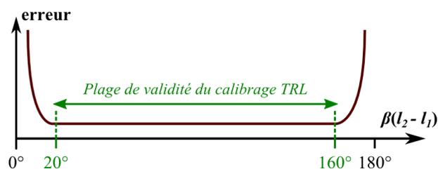
Fig. 30 - Plage de validité d'un calibrage *TRL*
