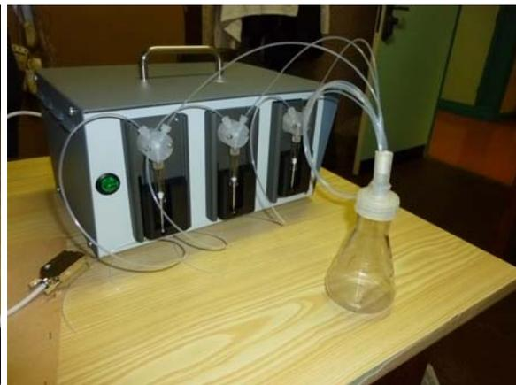
Photos du système des microburettes automatiques : vues intérieure et extérieure.
