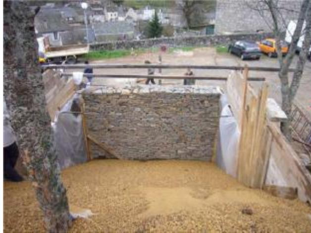
FIGURE 1.13: Mur de Colas chargé par un remblai depuis une benne [46]
