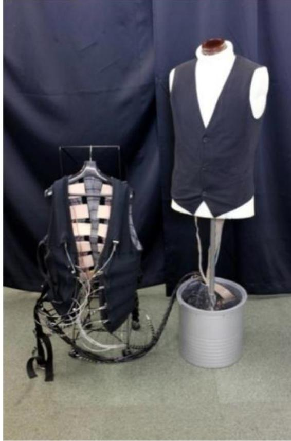
**Figure 50. Le système Sense-Roid : un mannequin équipé de capteurs, et une veste tactile (Takahashi et al., 2011).**
