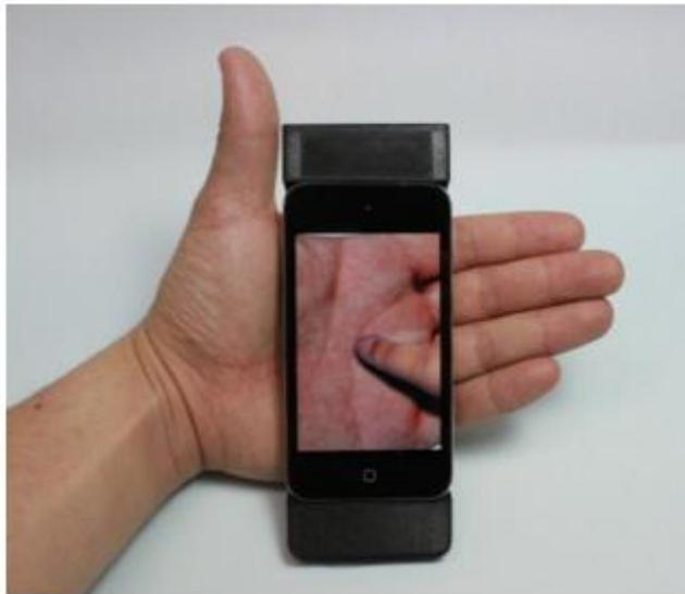
**Figure 45. Un utilisateur de KUSUGURI ayant la sensation d’être chatouillé par un utilisateur distant. Le doigt de l’autre participant se déplace sur l’image de sa propre paume et il reçoit une faible vibration synchronisée avec les mouvements du doigt, ce qui donne l’illusion d’être chatouillé (Furukawa, Kajimoto et Tachi, 2012).**
