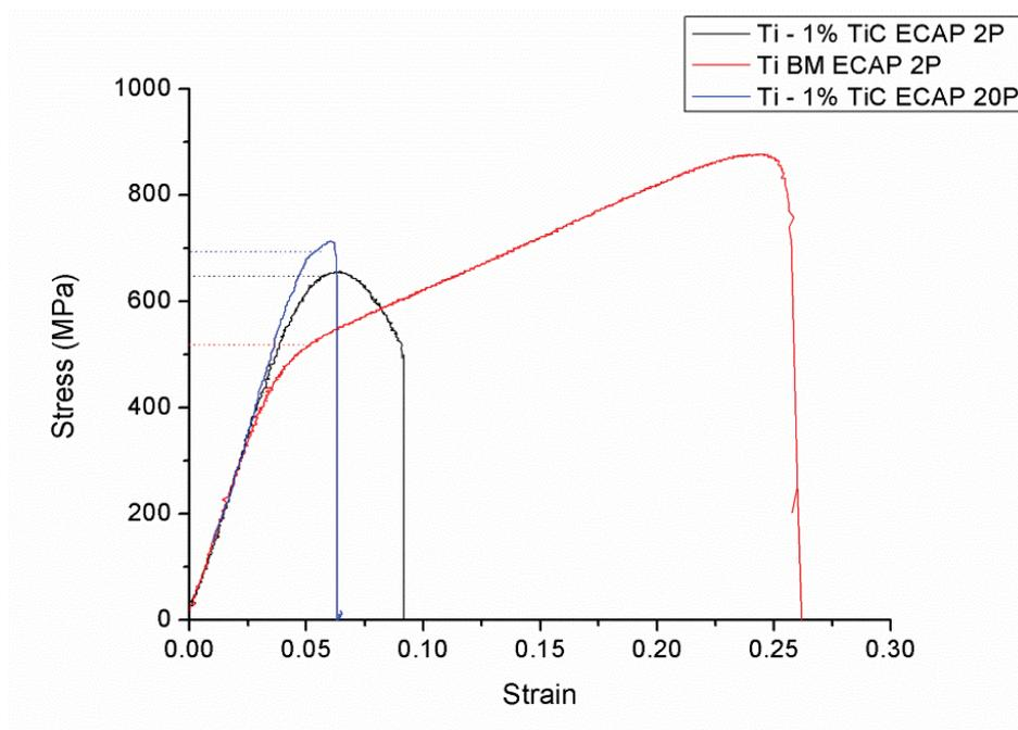
Ces travaux de thèse ont permis de montrer, par l'étude d'un modèle, la pertinence de fabriquer de tels matériaux composite à matrice de Titane (Ti-TiC et Ti-TiB). Des méthodes de métallurgie des
