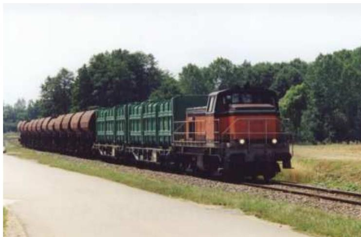
**Photo 6** Le locotracteur est réservé pour les dessertes terminales sur de faibles parcours
