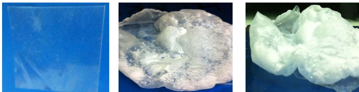
**Figure B-19 Membrane élastomère en PDMS. Gauche : membrane native; Centre et droite: membrane après expérience d'absorption du CO<sub>2</sub> dans l'ammoniaque**
