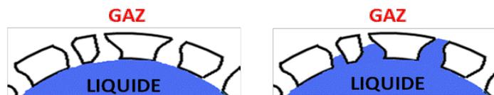
Figure A-12 Mouillage des membranes microporeuses
