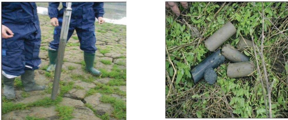
**FIGURE 4.** Prélèvement par carottier et échantillons d'un carottage.
