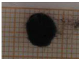
**Figure IV- 35 : Photos du monolithe préparé par voie alginate**
