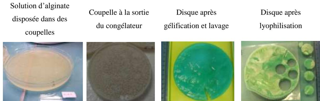
**Figure IV- 34 : Photos des différentes étapes de synthèse de l'oxyde de cuivre préparé à partir d'une solution à 4 % d'alginate**
