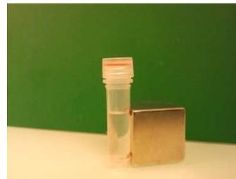
**Figure II-5b.** Témoin d'attraction par le macro-aimant : tube contenant des particules de  $1\mu\text{m}$  mis en contact du même aimant.
