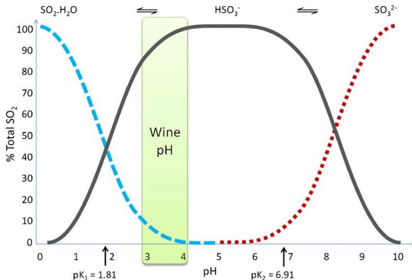
**Figure 5.** Les différentes formes du  $\text{SO}_2$  dans une solution aqueuse représentées en pourcentage par rapport au  $\text{SO}_2$  total et en fonction du pH du milieu.  $\text{pK}_1$  est la constante de dissociation de la réaction chimique  $\text{SO}_2 \cdot \text{H}_2\text{O} \leftrightarrow \text{HSO}_3^- + \text{H}^+$  et  $\text{pK}_2$  celle de la réaction  $\text{HSO}_3^- \leftrightarrow \text{SO}_3^{2-} + \text{H}^+$  (Divol et al., 2012).
