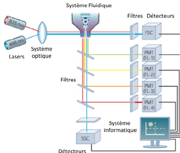
**Figure. 10: Représentation schématique d'un Cytomètre en flux (Rahman, 2006).**
