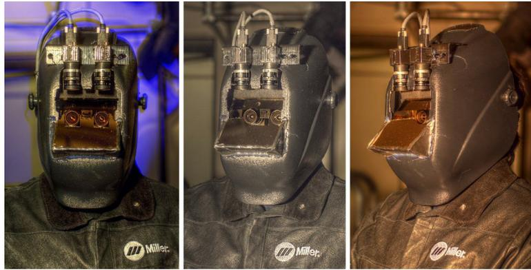
FIGURE 3.9 – Le système de casque de soudage "MannVis welding helmet" par Mann et al. [99].
