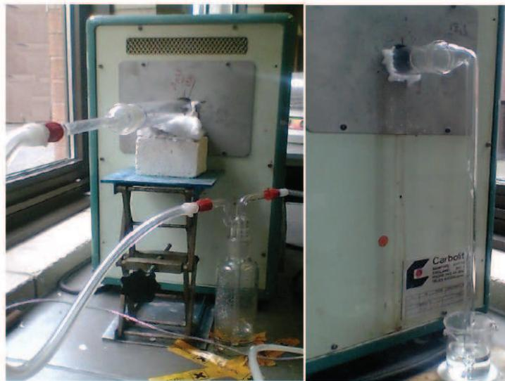
*Figure 8 : Photo d'analyseur d'azote <sup>[34]</sup>.*
