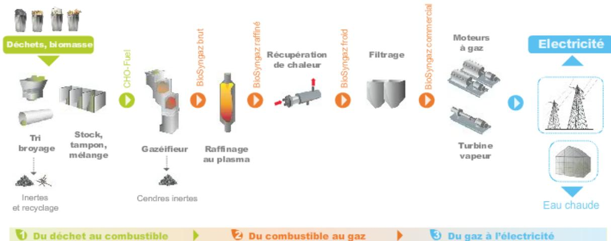
Figure 24 : Schéma de principe de CHO-Power
