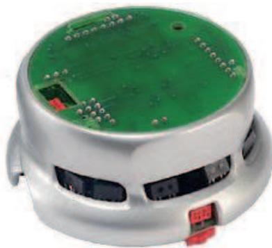
FIG. I.1 – Schéma du robot mobile Khepera II
