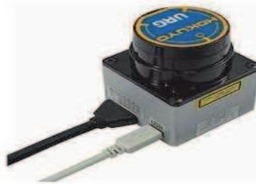
FIG. I.10 – Télémètre Laser de type URG-04X (Photo de la société Hokuyo Automatic Co., LTD).
