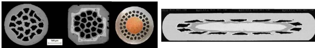
Figure I-6: Section de quelques conducteurs MgB2 [Colu12]
