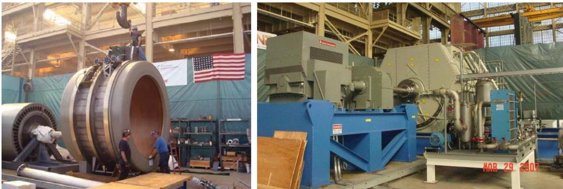
Figure I-17: Moteur HTc de propulsion de navire 36,5 MW construit par AMSC
