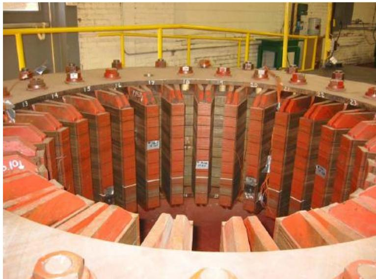
Figure 1.12 – Modèle d'un stator de turboalternateur [43]
