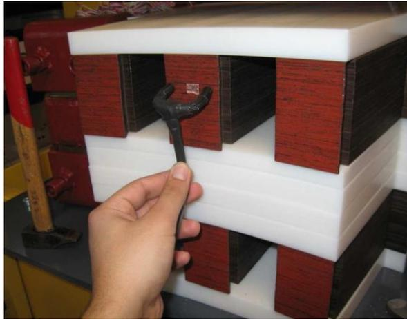
Figure 1.10 – Capteur El Cid devant un paquet de tôles avec défaut (maquette du LSEE<sup>1</sup>)
