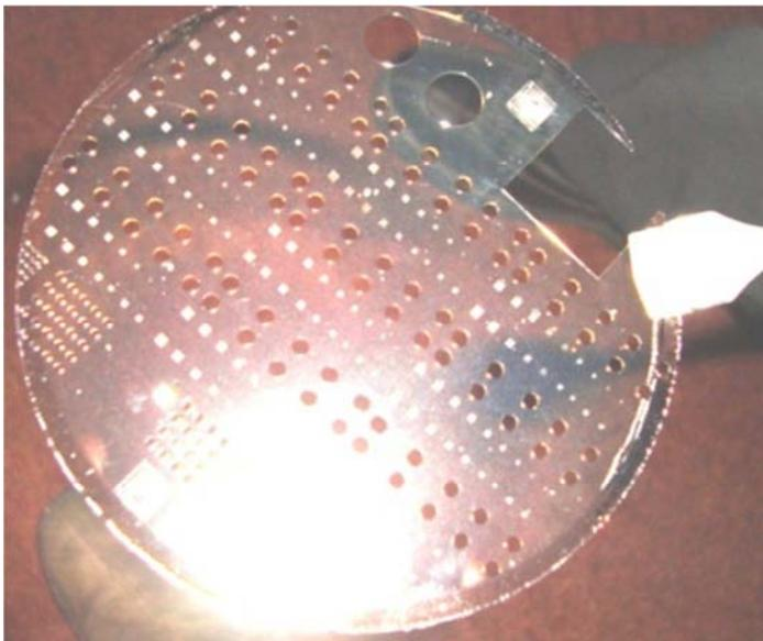
Fig. 2.6: Photo montrant un réseau de trous de diamètres 10 $\mu\text{m}$ , 20 $\mu\text{m}$ , autres dimensions ..., réalisés dans un film SU8 d'épaisseur 500 $\mu\text{m}$ .
