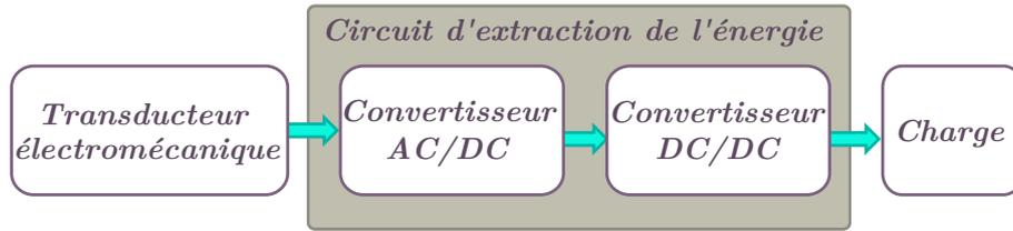
Figure 1.8 – Structure d'un circuit d'extraction classique.
