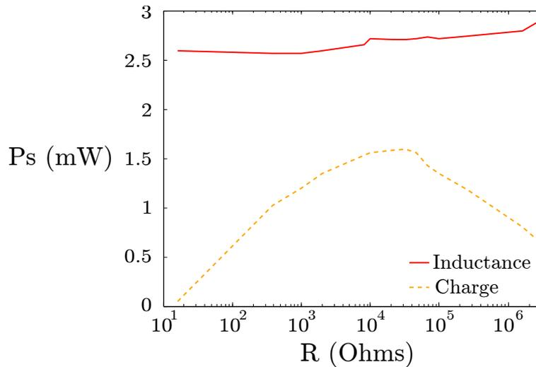
Figure 5.12 – Puissance récupérée avec la technique SMFE en fonction de la résistance de charge pour une fréquence de 98 Hz.
