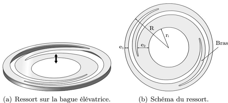
Figure 5.4 – Schémas du ressort spirale planaire.
