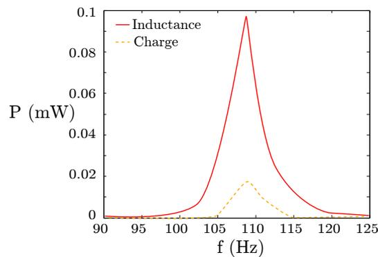
Figure 5.17 – Puissance récupérée avec la technique SMFE en fonction de la fréquence, pour une accélération de 0.2g.
