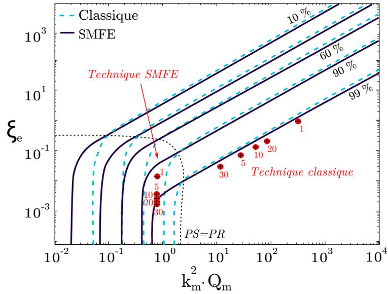
Figure 4.22 – Evolution du point de fonctionnement en fonction du volume pour l'optimisation adaptée à la technique classique ou SMFE.
