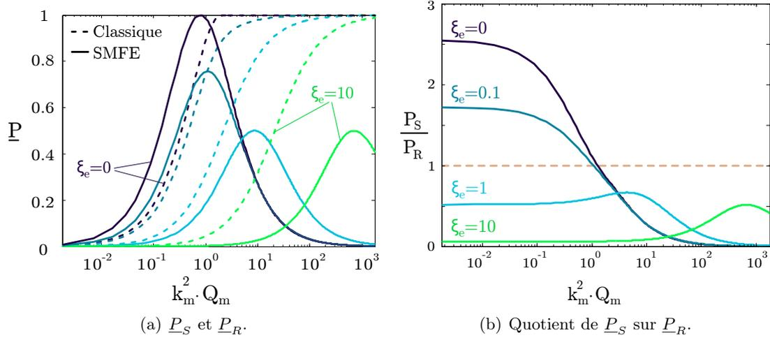
Figure 3.6 – Puissance normalisée avec la technique SMFE ( $\underline{P}_S$ ) et avec la technique classique ( $\underline{P}_R$ ), et quotient des deux, en fonction du produit  $k_m^2 \cdot Q_m$ , pour  $\xi_e$  variant de 0 à 10.
