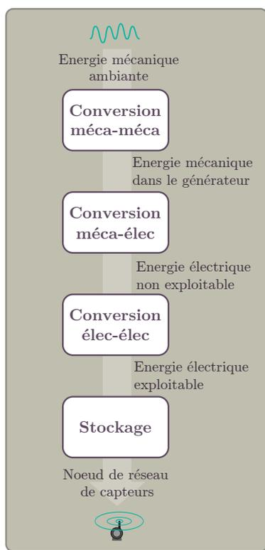
Figure 1.3 – Structure d'un récupérateur d'énergie vibratoire
