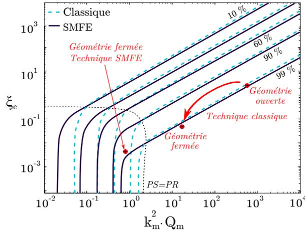
Figure 4.19 – Point de fonctionnement de la géométrie optimisée pour la technique classique ouverte ou fermée.
