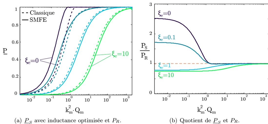
Figure 3.9 – Puissance normalisée avec la technique SMFE ( $\underline{P}_S$ ) avec inductance optimale et avec la technique classique ( $\underline{P}_R$ ), et quotient des deux, en fonction du produit  $k_m^2 \cdot Q_m$ , pour  $\xi_e$  variant de 0 à 10.
