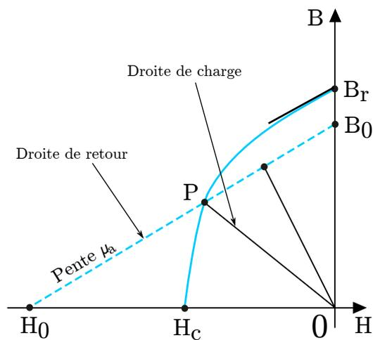
Figure 4.6 – Point de fonctionnement et droite de retour.
