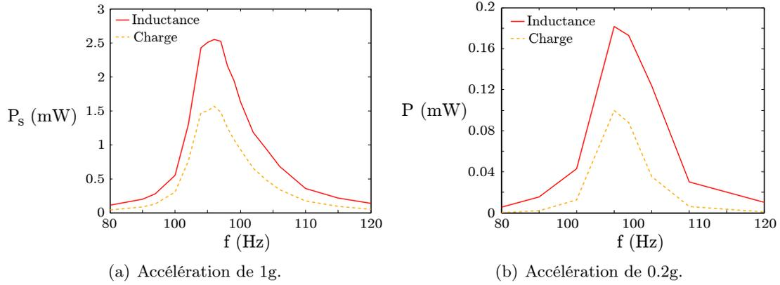
Figure 5.11 – Puissance récupérée avec la technique SMFE en fonction de la fréquence, pour une résistance de charge de 10 kΩ et des accélérations de 1g et 0.2g.
