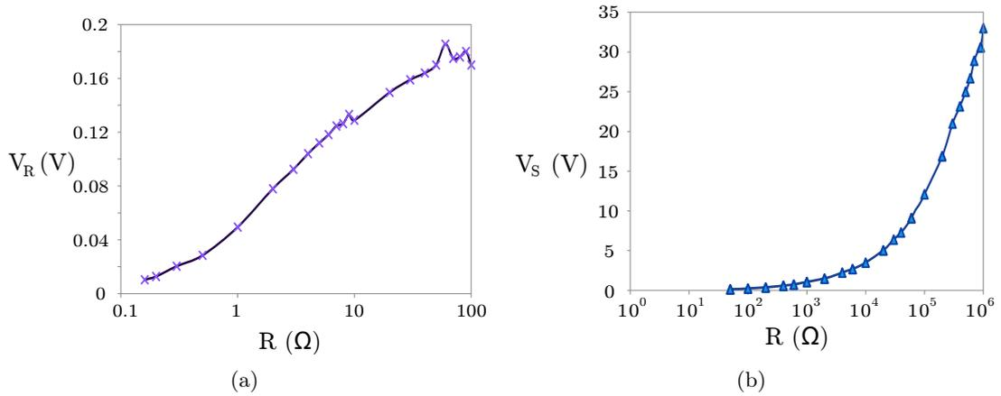
Figure 3.19 – Tension expérimentale et théorique récupérée avec la technique SMFE et la technique classique.
