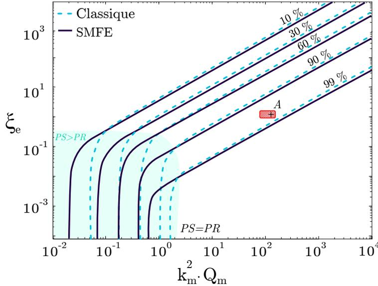
Figure 5.13 – Point de fonctionnement du générateur dans le plan  $(k_m^2 \cdot Q_m, \xi_e)$ .
