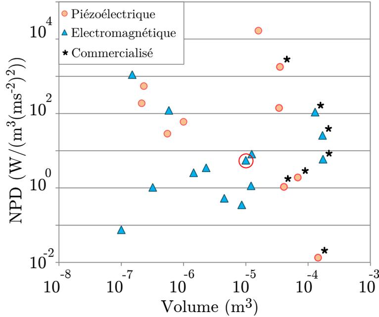
Figure 5.19 – Densité de puissance normalisée du prototype développé en comparaison avec les générateurs de la littérature présentés chapitre 1.
