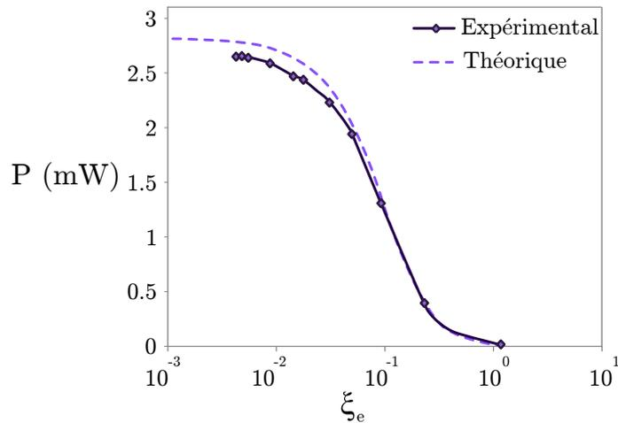
Figure 2.16 – Puissance en fonction du coefficient de pertes pour le PEG.
