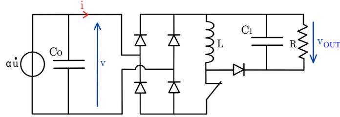
Figure 3.1 – Circuit d'extraction SECE pour les générateurs piézoélectriques.
