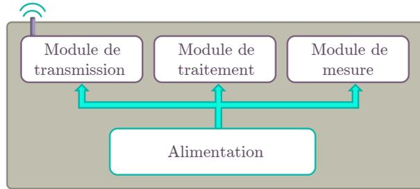
Figure 1.1 – Structure d'un nœud de réseau de capteurs
