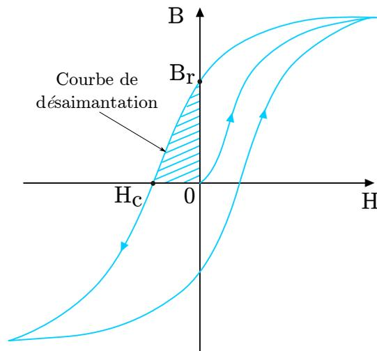
Figure 4.4 – Cycle d'hystérésis et points caractéristiques.
