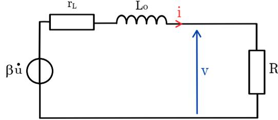
Figure 2.4 – Circuit d'extraction classique simplifié pour un EMG.
