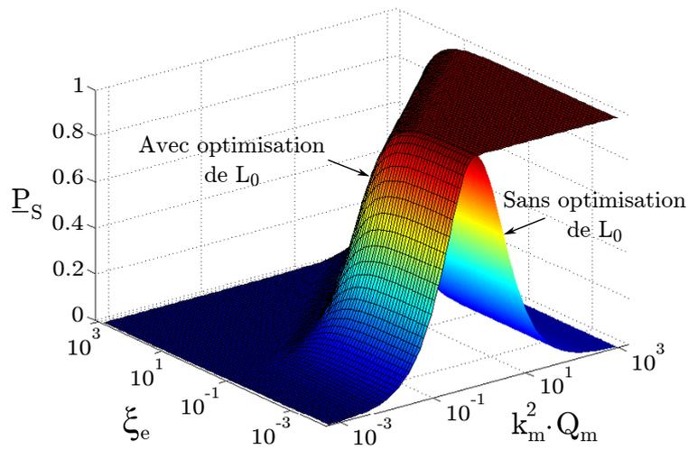
Figure 3.7 –  $\underline{P}_S$  avec ou sans inductance optimale, en fonction du produit  $k_m^2 \cdot Q_m$ , et de  $\xi_e$ .
