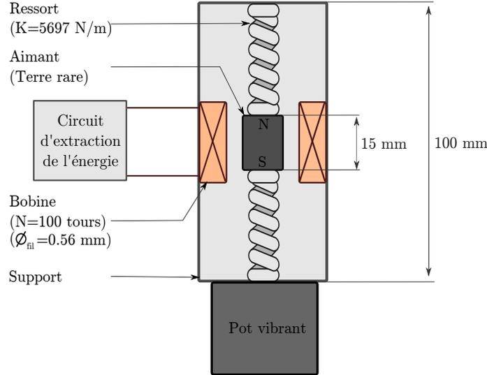
Figure 3.15 – Schéma du générateur utilisé.
