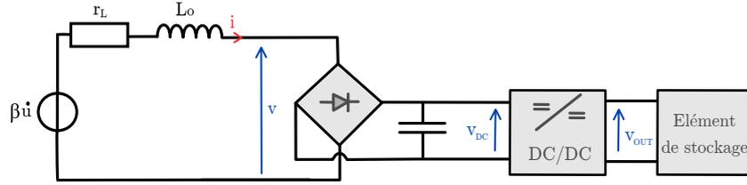
Figure 2.3 – Circuit d'extraction classique pour un EMG.
