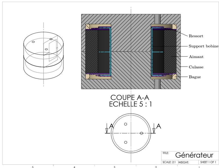
Figure 5.1 – Coupe de l'assemblage final.
