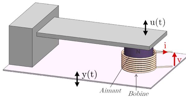
Figure 1.4 – Exemple de structure de transducteur électromagnétique
