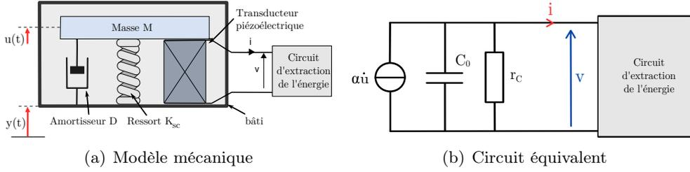
Figure 2.1 – Modèle d'un générateur piézoélectrique.
