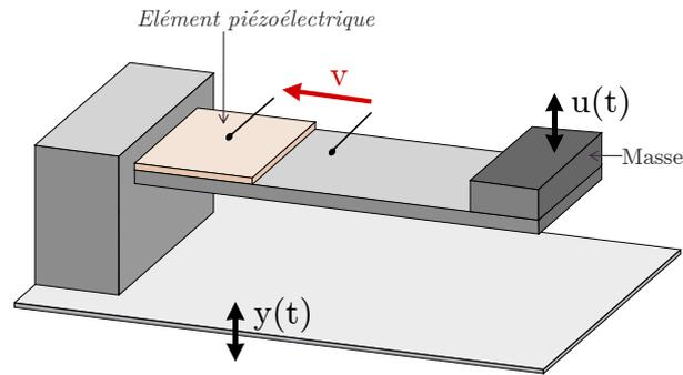
Figure 1.5 – Exemple de structure de transducteur piézoélectrique
