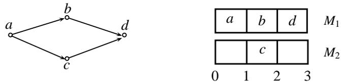
Fig. 4.1 – Ordonnancement d’un graphe de précédence avec 4 tâches unitaires : les tâches  $a$ ,  $b$  et  $d$  s’exécutent sur la machine  $M_1$  et la tâche  $c$  sur la machine  $M_2$ .
