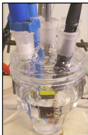
Figure A : Montage électrochimique utilisé pour la synthèse de la birnessite
