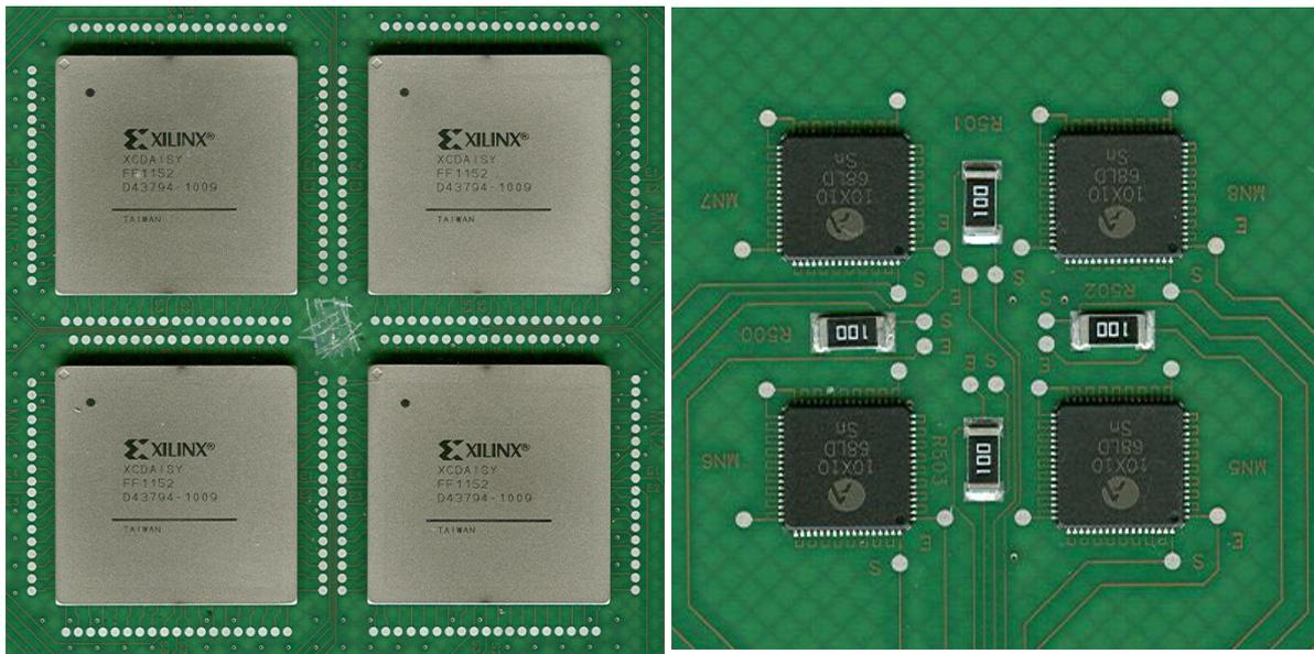
Figure III-53 : véhicules de test BGA et QFN
