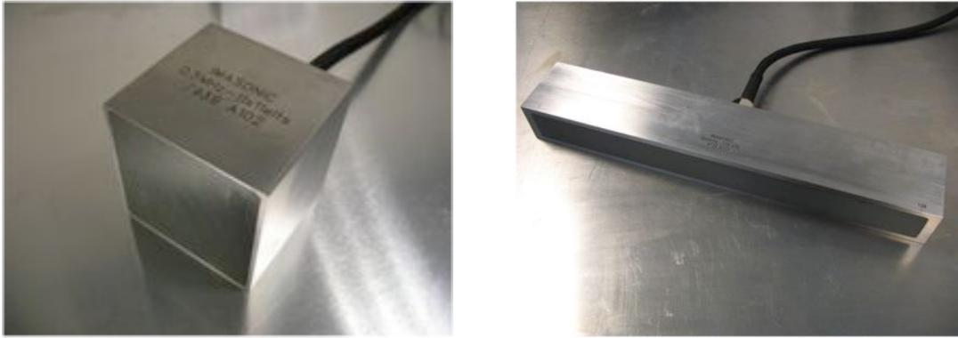
Figure 3.10 : Photographies des sondes multiéléments *Imasonic* : (a) sonde matricielle carrée 121 éléments, (b) sonde linéaire 128 éléments.
