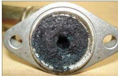
FIGURE 2.1.9 – Exemple d'un encrassement de la boucle EGR entraînant une réduction de la perméabilité (rétrécissement de la section tube) [16]
