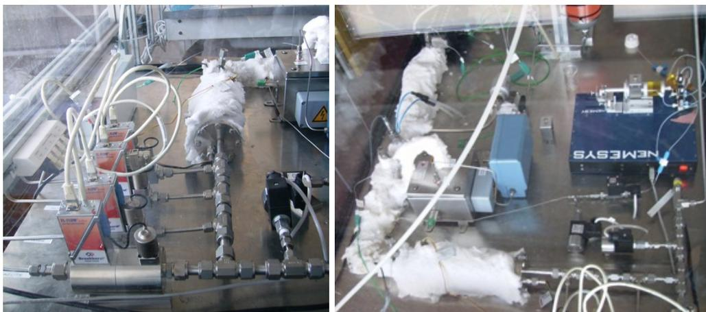
FIGURE 3.4.1 – Photo de la partie alimentation : l'injection des gaz (à gauche) et des liquides (à droite)
