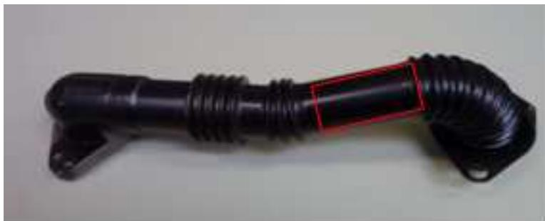
FIGURE F.0.1 – Premier tube testé avec la caméra Infra-rouge
