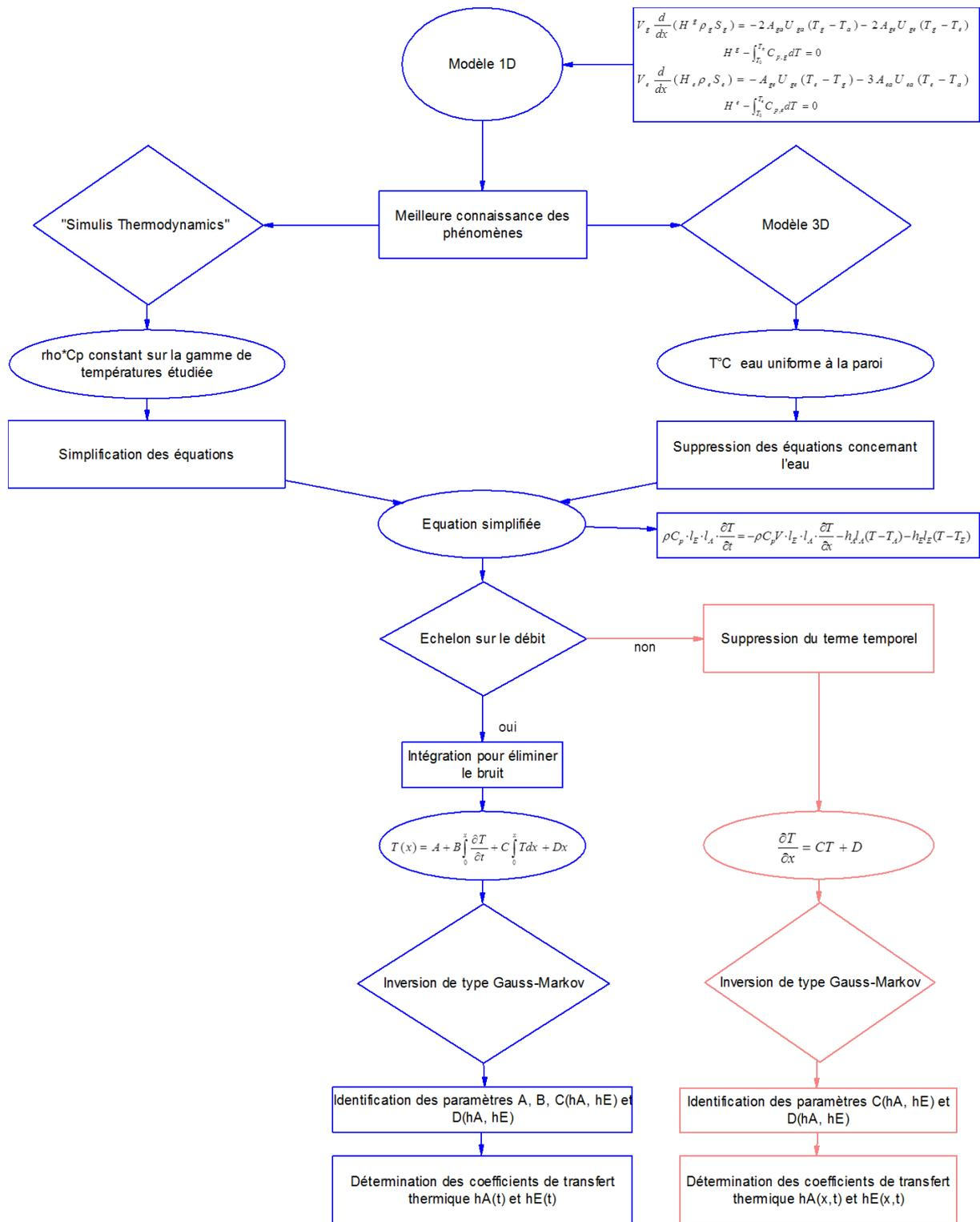
FIGURE 5.0.1 – Logigramme représentant les différentes étapes qui ont mené à la détermination des coefficients de transferts thermiques, dépendants de l'épaisseur du dépôt d'encrassement
