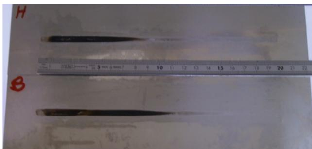
FIGURE 4.2.5 – Dépôt après une « expérience 0 » sur les clinquants du dessus (H) et du bas (B)
