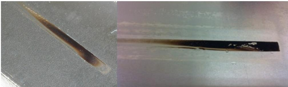
FIGURE G.3.2 – Dissymétrie des dépôts liée à la présence du thermocouple.
