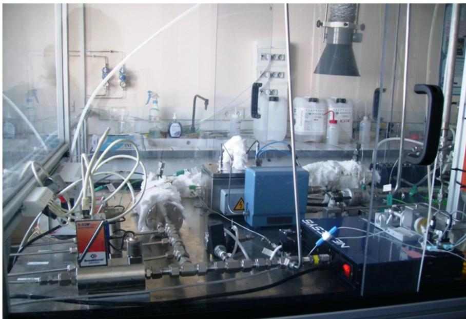
FIGURE 3.1.2 – Photo des parties « alimentation » et « chauffage » du montage expérimental
