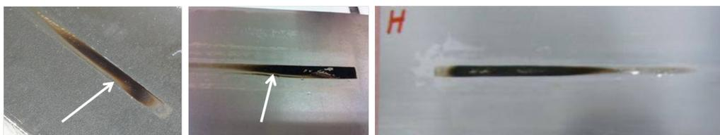
FIGURE 4.3.1 – Essais d'encrassement dans les conditions opératoires du type « Expérience 0 » (Tabs. 4.2.2 et 4.2.5). Dans les essais A et B (clichés gauche et milieu), l'insertion d'un thermocouple dans l'échangeur limite le dépôt par rapport à l'essai C (cliché de droite) effectué sans ce thermocouple.
