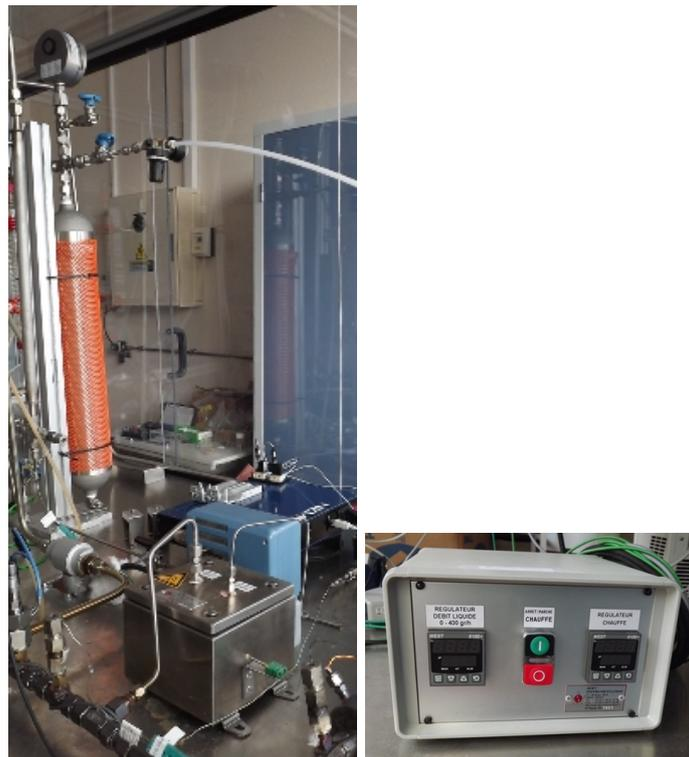
FIGURE 3.5.6 – Photo du vaporisateur (à gauche) et les régulateurs WEST (à droite)
