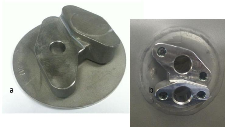
Figure 5-2, Bossage support injecteur et bougie de démarrage
