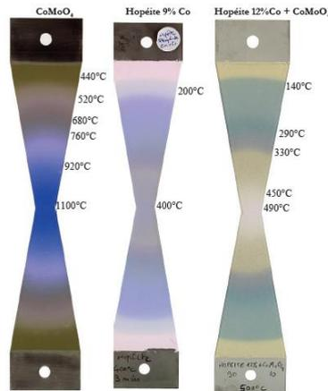
Figure 4-3, Exemples de relevés de température obtenus sur des éprouvettes chauffées par le centre [69]
