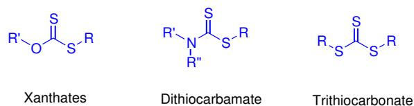
Figure 1.41 – Formule semi-développée générale de xanthates et d'agents RAFT.
