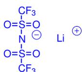
**Figure 1.23** – Formule semi-développée du sel LiTFSI.
