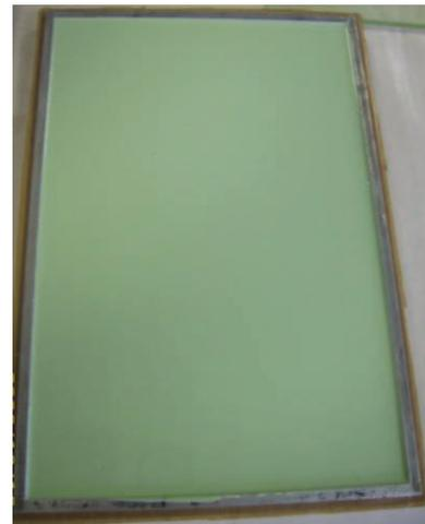
Figure III-27 : Plaque pour traction
