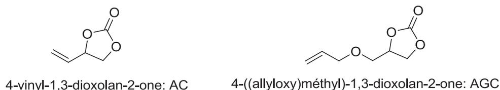
Figure II-35 : Cyclocarbonates utilisés pour synthétiser les dicyclocarbonates par la méthode thiol-ène.
