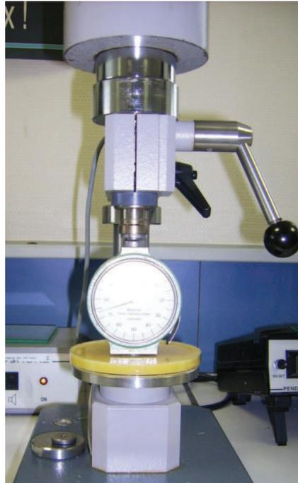
*Figure IV-1 : Duromètre utilisé pour la détermination de la dureté Shore*
