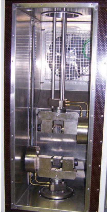
*Figure IV-2 : Appareil de traction avec enceinte thermostatée*
