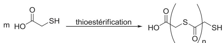
Figure II-41 : Réaction parasite d'auto-condensation de l'acide thioglycolique.
