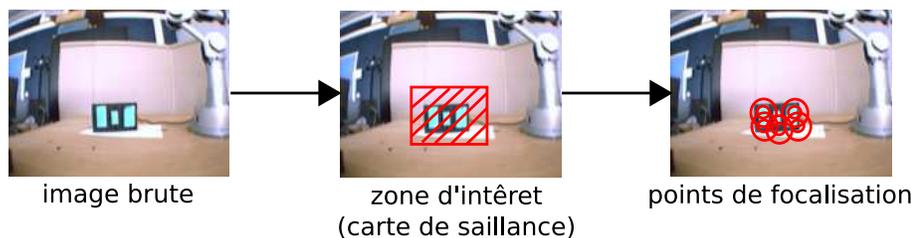
**Fig. 7-8** – Chaîne de traitement visuelle. Le robot focalise sur une zone d'intérêt dans l'environnement (zone saillante: couleurs et textures). Une fois cette zone sélectionnées, des points de focalisations sont extraits sur cette zone grâce aux Différences de Gaussiennes (DOG).
