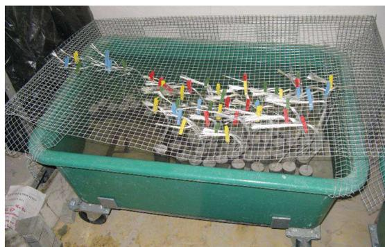
**Figure 2.41.** Conservation des éprouvettes sous l'eau.
