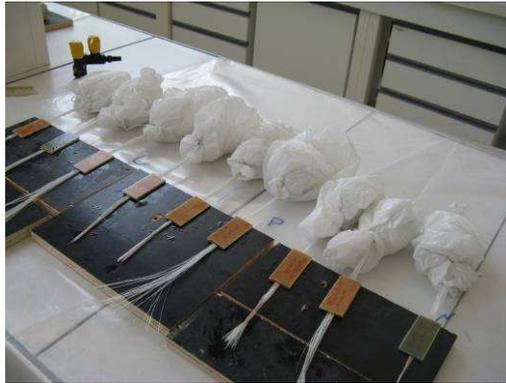
**Figure 4.2.** Protection des éprouvettes de la dessiccation lors de la préparation des éprouvettes d'arrachement.
