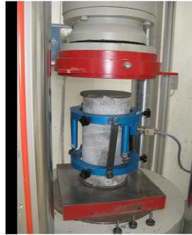
Figure 2.48. Essai extensométrique sur éprouvette cylindrique 16\*32 cm.
