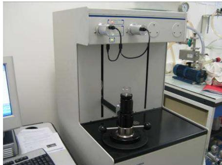
**Figure 3.30.** Appareil de porosité à mercure AUTOPORE IV 9500.
