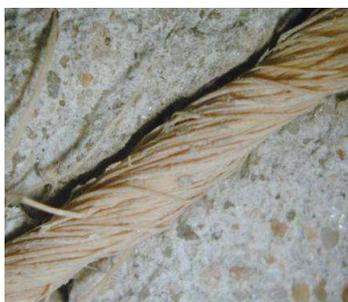
**Figure 2.7.** Fils de fibre de chanvre.
