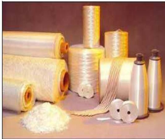
**Figure 1.3.** Bobines à fil (à droite et au centre), bandes tressées (au centre) et textiles tissés (à gauche) à base de fils multi-filamentaires de verre et tas de fibres courtes (au premier plan à gauche) [Won04].
