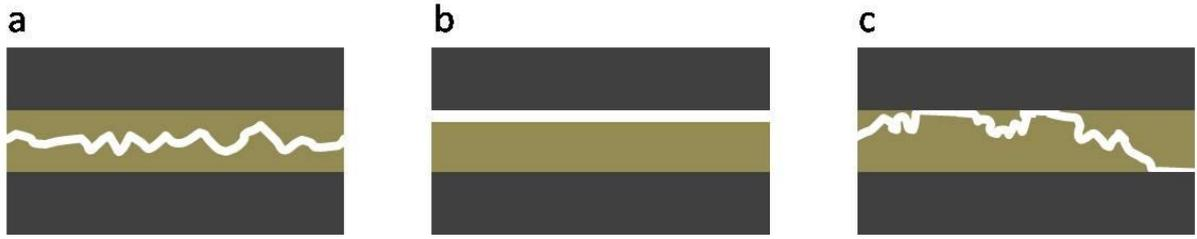
Figure I.12. Modes de rupture. (a) Rupture cohésive, (b) rupture adhésive et (c) rupture mixte.
