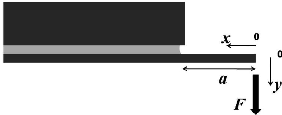
Figure II.12. Représentation schématique de l'essai à simple levier (SCB)
