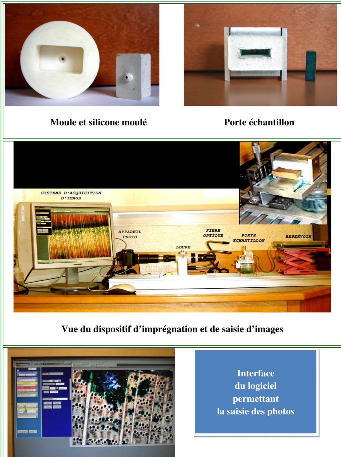
*Figure II-2 : Montage expérimental conçu pour l'étude de la cinétique d'écoulement capillaire de l'eau colorée à travers le bois au cours du temps*
