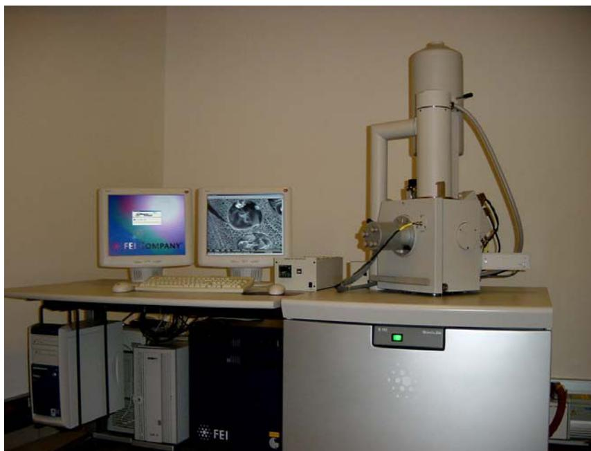
*Figure II-5 : Microscope électronique à balayage environnemental (ENGREF).*
