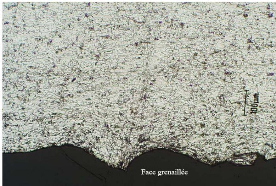
Figure I-31 : Micrographie d'un Al2017A grenailé.
