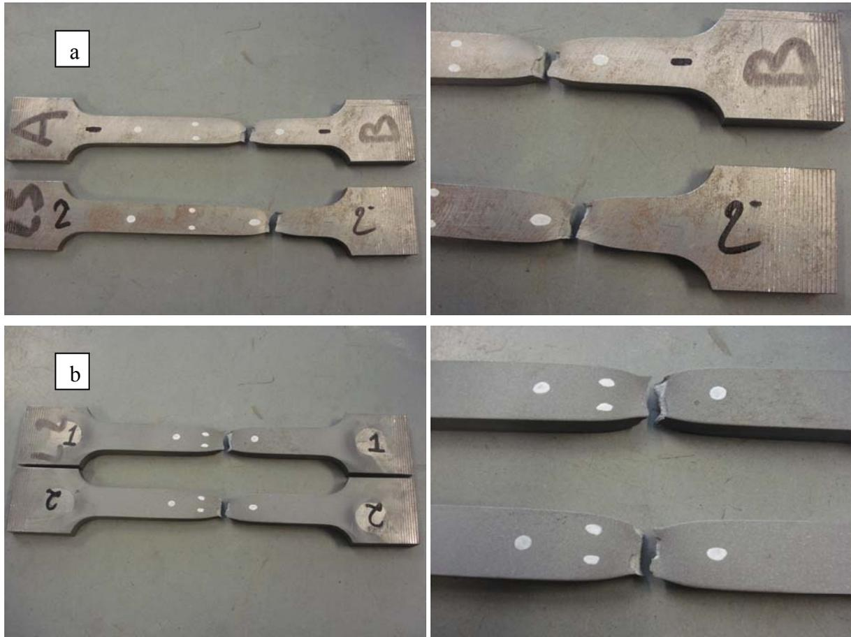
**Figure III-4 : Epruvettes L après rupture :**
