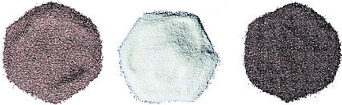
Figure II-9 : Photographie du corindon brun, blanc et semi-friable respectivement.
