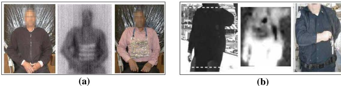
Figure I-6: l'ensemble des images (a) et (b) montre la dissimulation d'une arme de poing. Chaque image montre le visible (plus à gauche), la révélation par l'imagerie (au centre) puis une image visible de l'arme exposée. L'image la plus à gauche en (b) est prise dans des conditions simulant un environnement froid [I-12]
