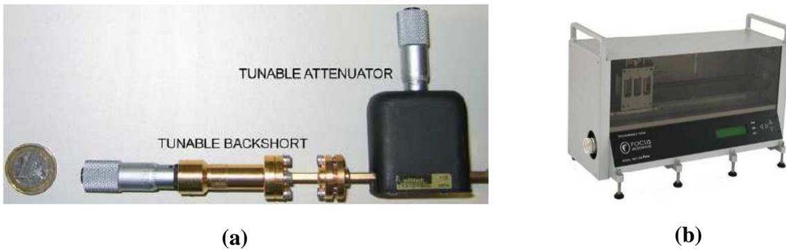
Figure I-24: (a) Tuner d'impédance mécanique manuel utilisé en bande W (75-110 GHz) [I-43], (b) Tuner d'impédance mécanique programmable [I-44].
