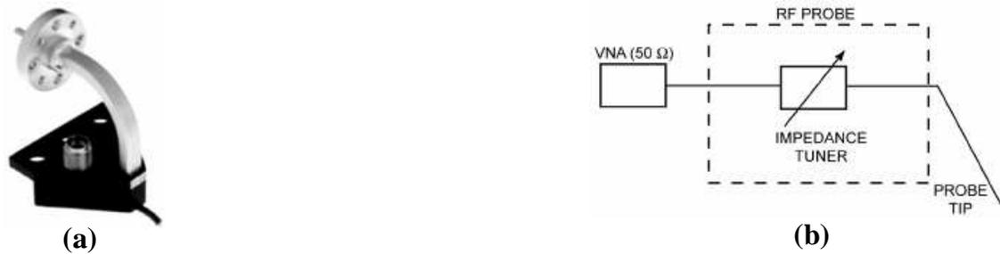
Figure I-26: (a) Sonde RF avec une pré-adaptation intégrée pour la mesure sous pointe en bande W, (b) représentation du schéma équivalent interne de la sonde RF [I-45]
