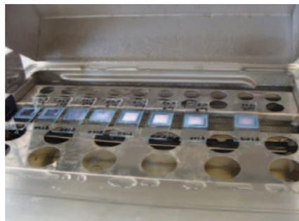
**Figure II 31** : Mode de chauffage des systèmes, face lamelle en bas. Le carré bleu est le « GENE FRAME<sup>®</sup> »
