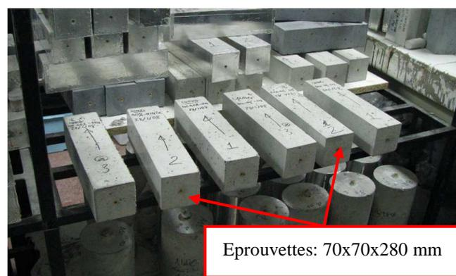
Figure III-25 : Conservation des éprouvettes pour essais de retrait (salle  $20 \pm 1^\circ\text{C}$  et  $50 \pm 5\%$  HR).
