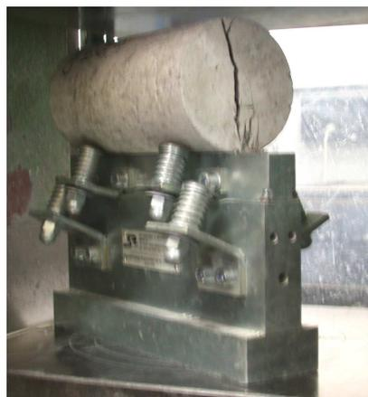
Figure III-7 : Eprouvette cylindrique reposant sur le support dédié après l'essai de traction indirecte par fendage.
