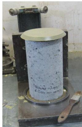
Figure II-8 : Surfaçage d'une éprouvette par l'enduit au soufre.
