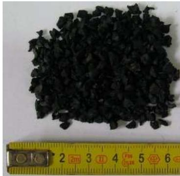
Figure II-2 : Granulats en caoutchouc de classe (0/4) mm utilisés.
