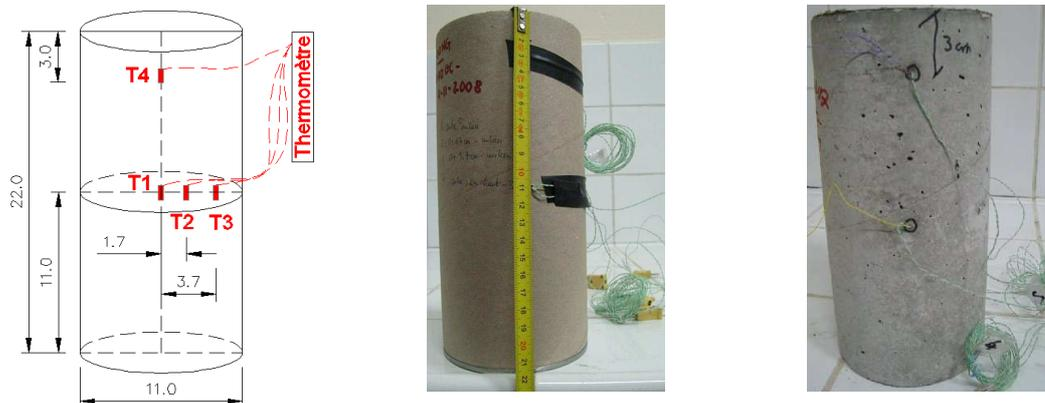
Schéma des thermocouples (cm)
