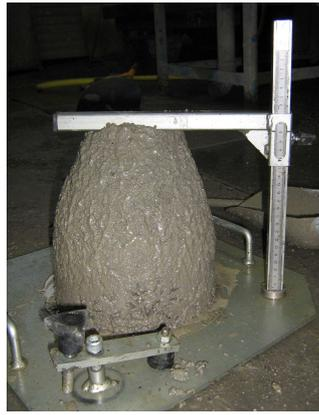
Figure II-5 : Illustration de l'essai d'affaissement de cône d'Abrams.
