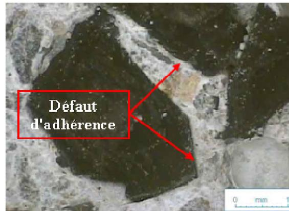
Figure III-2 : Défaut d'adhérence entre le caoutchouc et la matrice cimentaire vu au vidéo-microscope, (grossissement x100).
