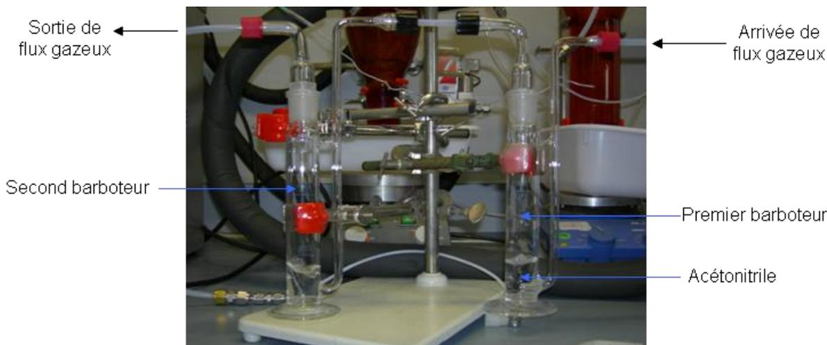
**Figure 5- 1 :** *Système de barbotage utilisé pour les mesures de concentrations de DNT générées.*
