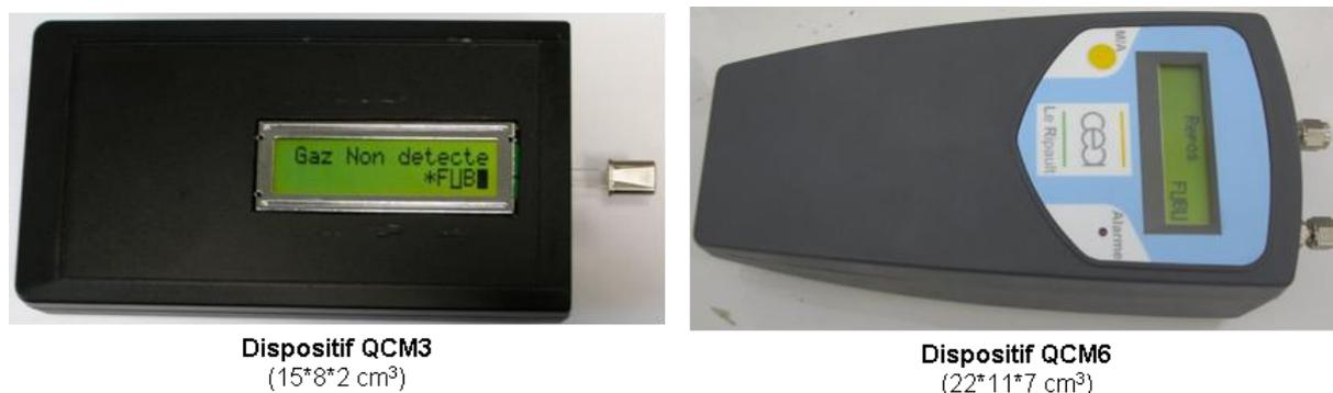
Figure 2- 11 : Présentation des dispositifs de détection par microbalance à quartz QCM3 et QCM6.
