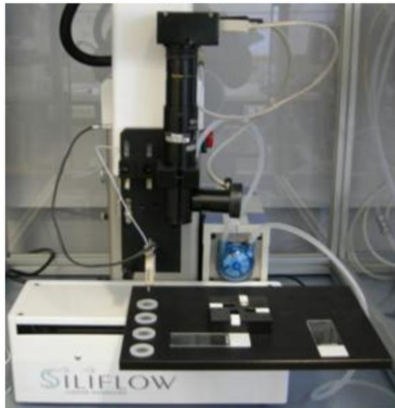
**Figure 2- 3 :** Dispositif de dépôt par Jet d'encre Silliflow LHMate<sup>®</sup>.
