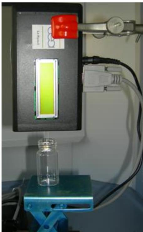
**Figure 6- 28 :** Photographie du dispositif mis en place pour la détection de peroxyde par microbalance.
