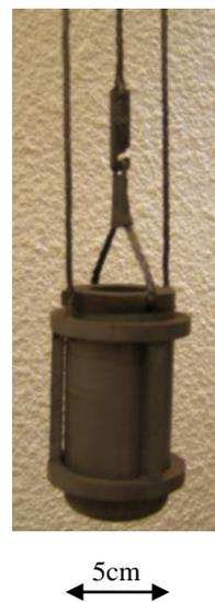
Figure 24: Nacelle et son dispositif de guidage
