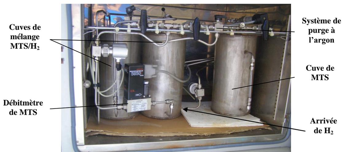
Figure 33 : Schéma de fonctionnement de l'étuve thermostatée utilisée pour le procédé SiC
