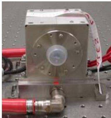
Figure 4.2 La DPCH : chambre pompée par diode.
