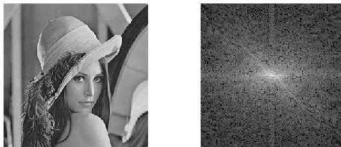
FIG. 1.4: Exemple d'une transformée de fourier
