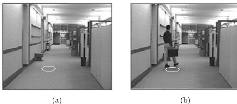
FIG. 7.4: Localisation de la zone d'ombre à deux instants différents. (a) Image de référence prise à l'instant  $t$ . (b) Image étudiée prise à l'instant  $t + n$ .
