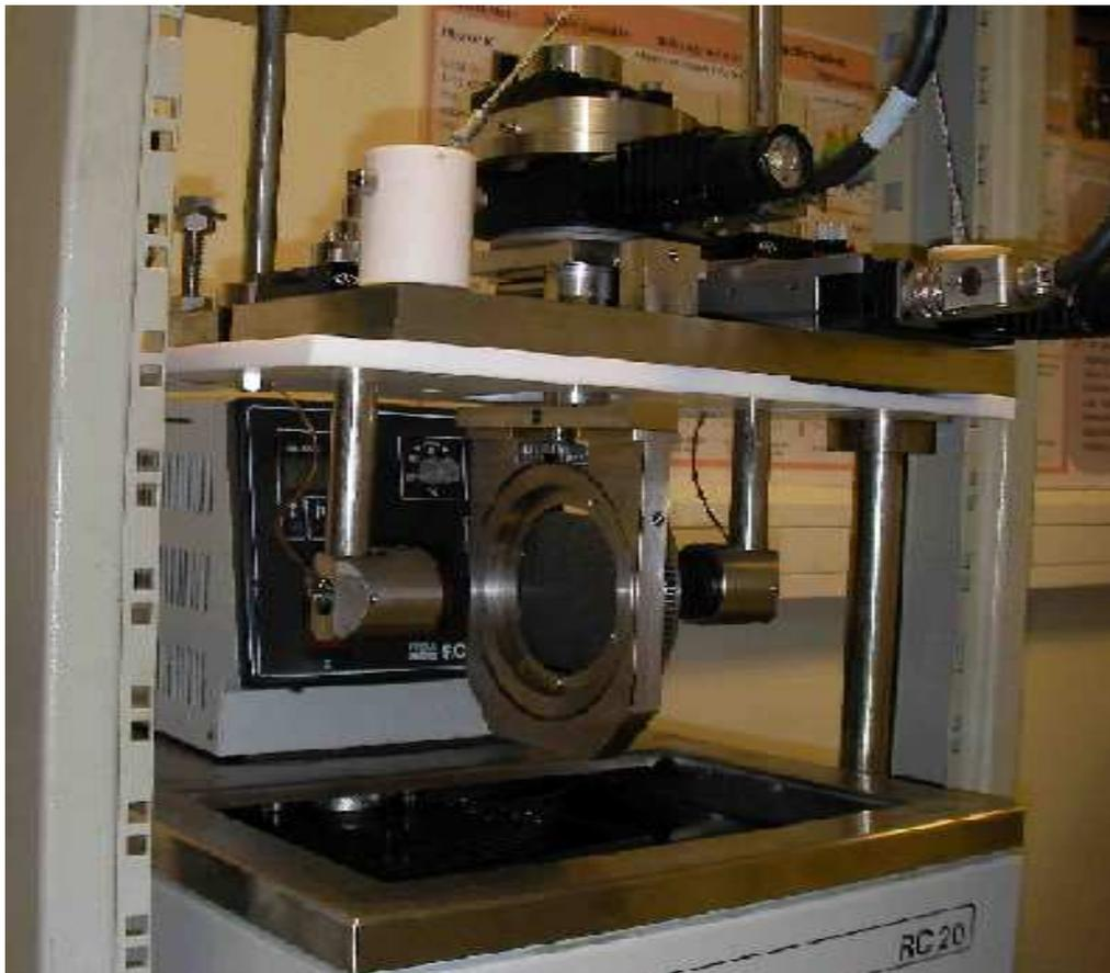
Figure IV.1 : Banc ultrasonore à immersion.
