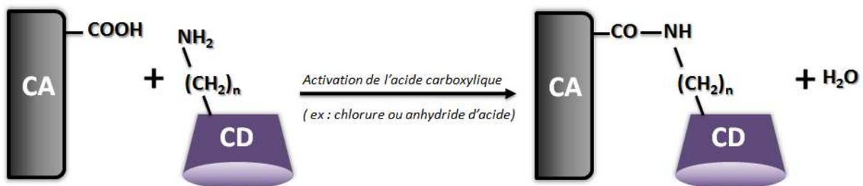
**Figure A.** Principe de synthèse de charbons actifs mésoporeux modifiés par des cyclodextrines par greffage.
