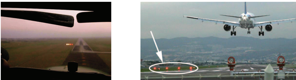
FIGURE 1.3 – Le PAPI ( Precision Approach Path Indicator ) est un système lumineux d’aide à l’atterrissage composé de quatre unités lumineuses positionnées au niveau du point de visée.
